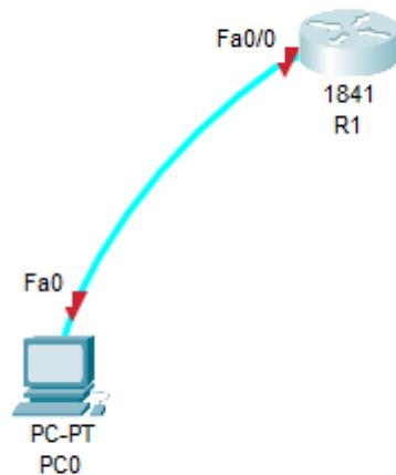
1. Spojiti usmjernik R1 sa računalom u ulozi terminala, rollover kabelom, kao na slici.
